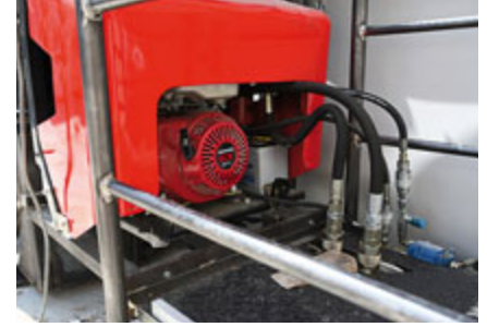
Für den hydrostatischen Fahrtrieb ist die Arbeitsbühne mit einem eigenen Motor ausgestattet.
