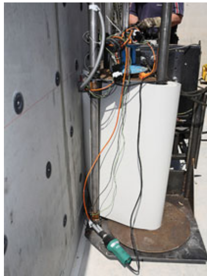
Beim Prototypen der mobilen Montagebühne waren das temperaturgesteuerte Heißluftgebläse und die Kabelverlegung noch provisorisch – um so besser ist das Grundprinzip der Technik erkennbar.
